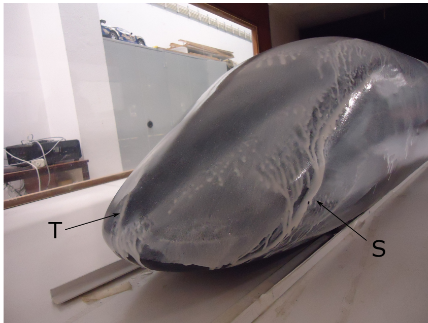
Figura 5.12: Regiões onde aparenta existir convergência das linhas de tensão de corte superficiais. Essas linhas não são claras na fotografia mas são mais visíveis a olho nú.
