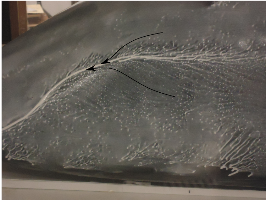
Figura 5.9: Zona indicadora de separação na região da traseira com indicação da direcção local das linhas de corrente limites.
