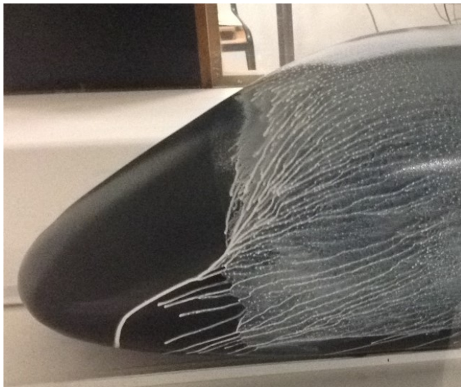
(a) Película de óleo demasiado espessa, ainda pouco estirada pelo escoamento de ar.
