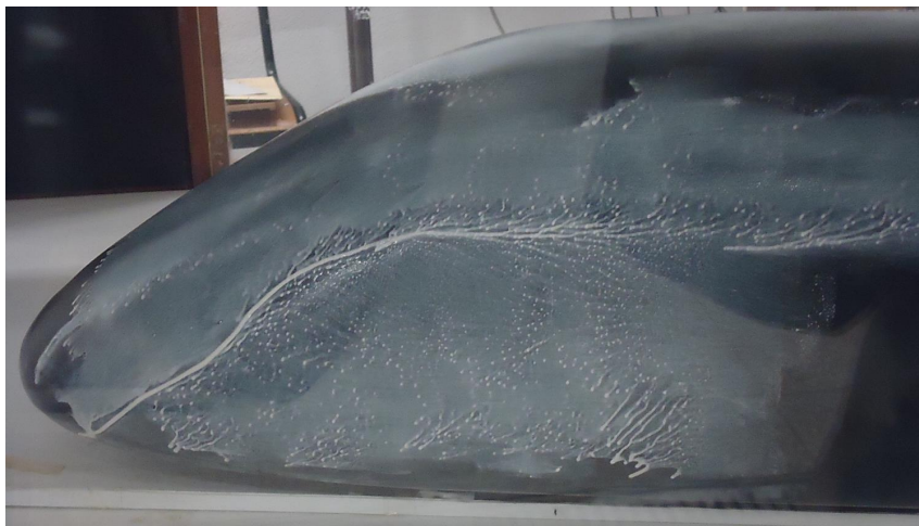
Figura 5.10: Extensão da linha de convergência indicadora de separação na região da traseira do modelo.
